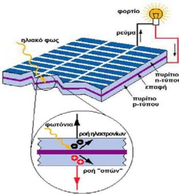
**Εικόνα 7.1: Λειτουργία ΦΒ κυττάρου (Πηγή: Ομάδα Φωτοβολταϊκής Τεχνολογίας Πανεπιστήμιο Κύπρου)**
