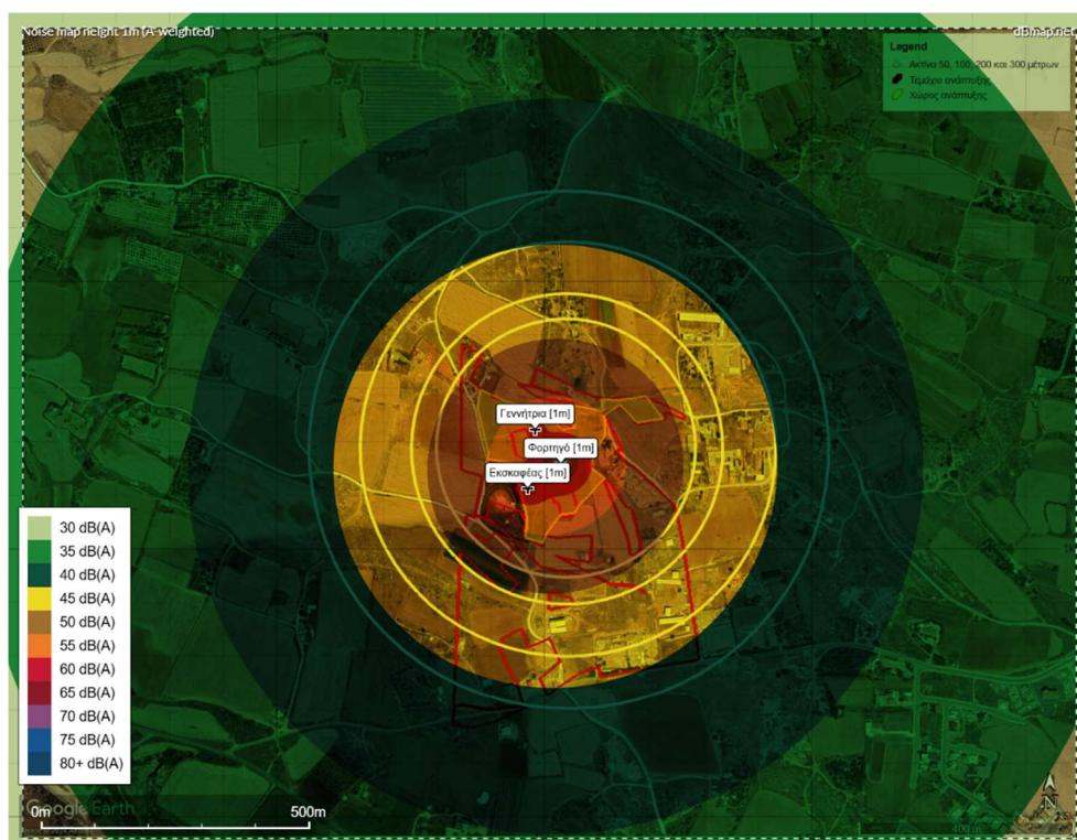
Εικόνα 10.2: Αναμενόμενο επίπεδο έντασης θορύβου  $L_{den}$  (dB(A)) κατά το στάδιο κατασκευής
