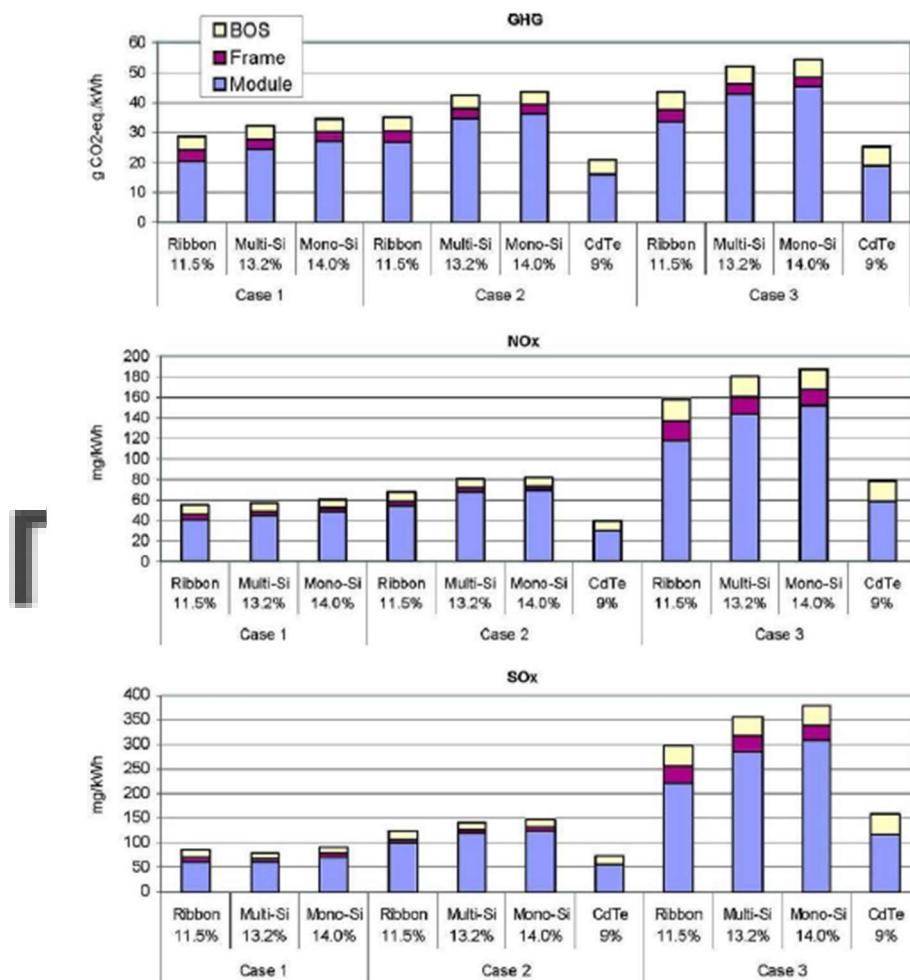
Εικόνα 7.10: Ανάλυση αέριων εκπομπών κύκλου ζωής ενός ΦΒ συστήματος
